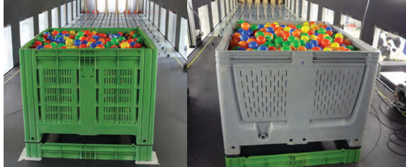
Versuche zur Durchströmung von Großkisten im Windkanal des ATB (Foto:ATB)
